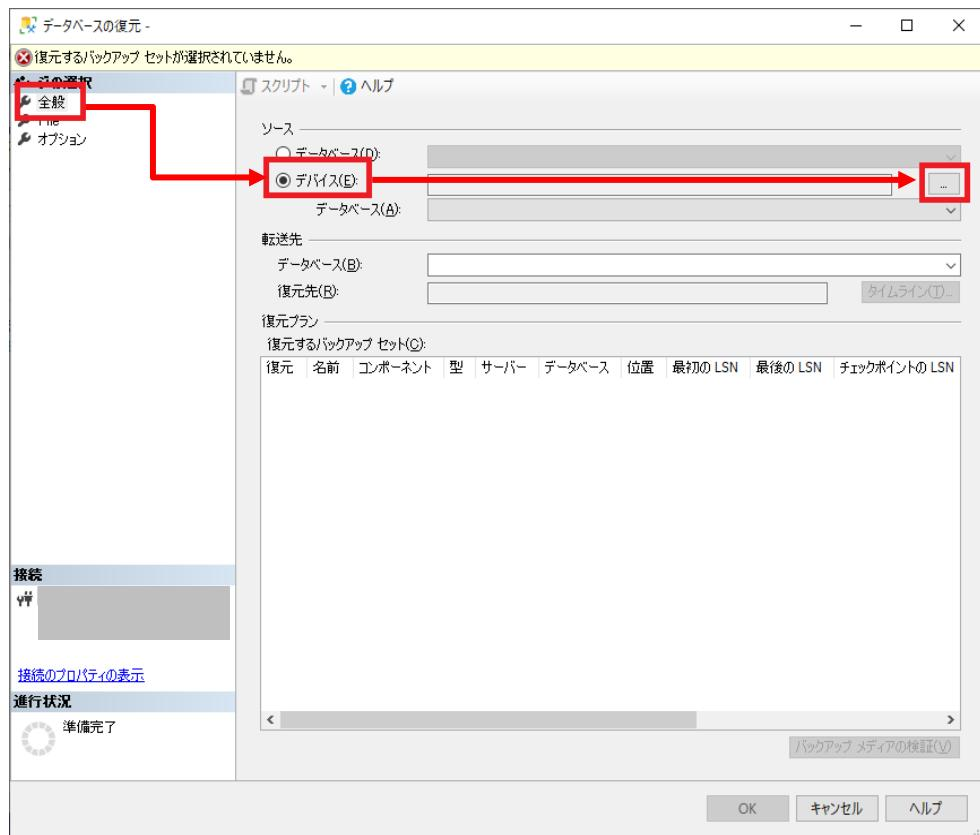
6. [バックアップデバイスの選択]画面で、以下の設定になっていることを確認し、[追加]をクリックします。
