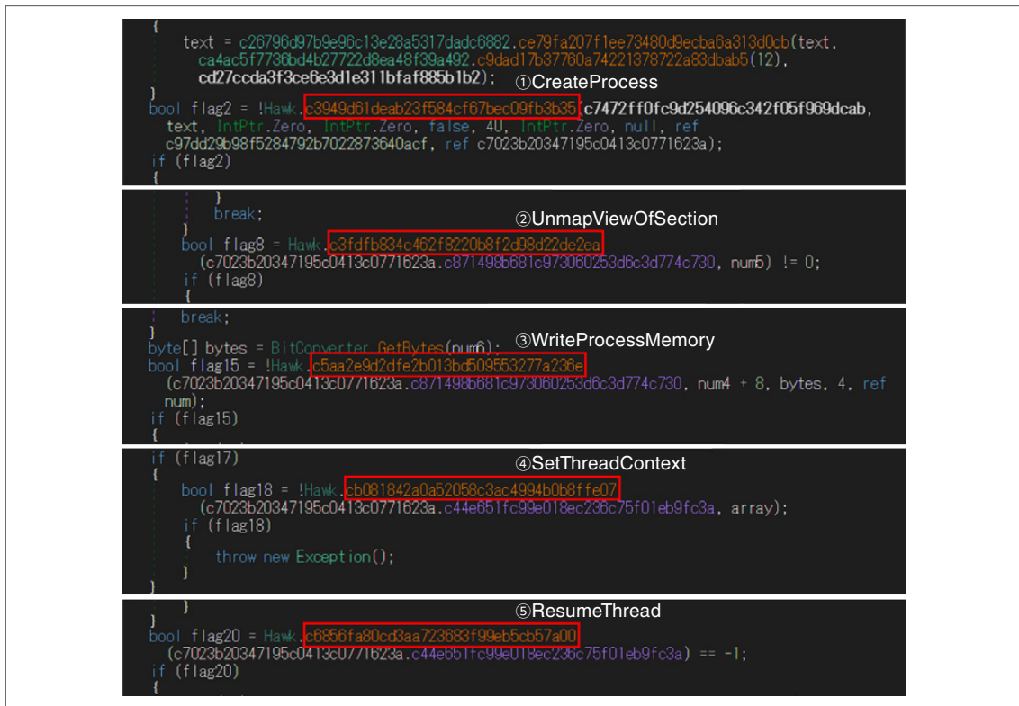
図 2-9 Process Hollowingの処理の流れ
