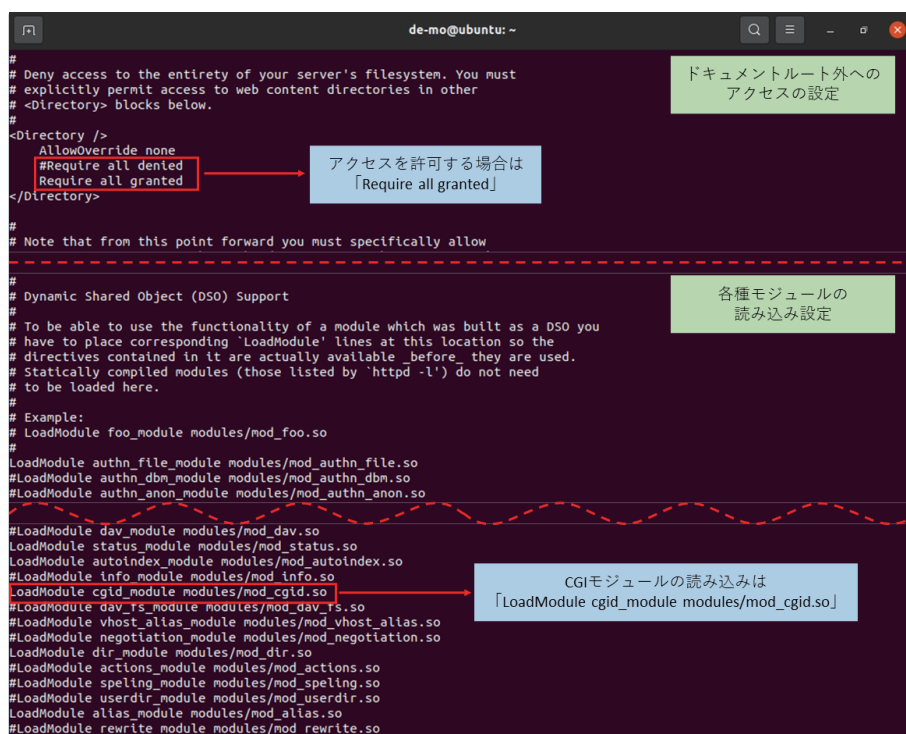
図 5.2 Apache HTTP Serverのhttpd.confファイルの設定画面
